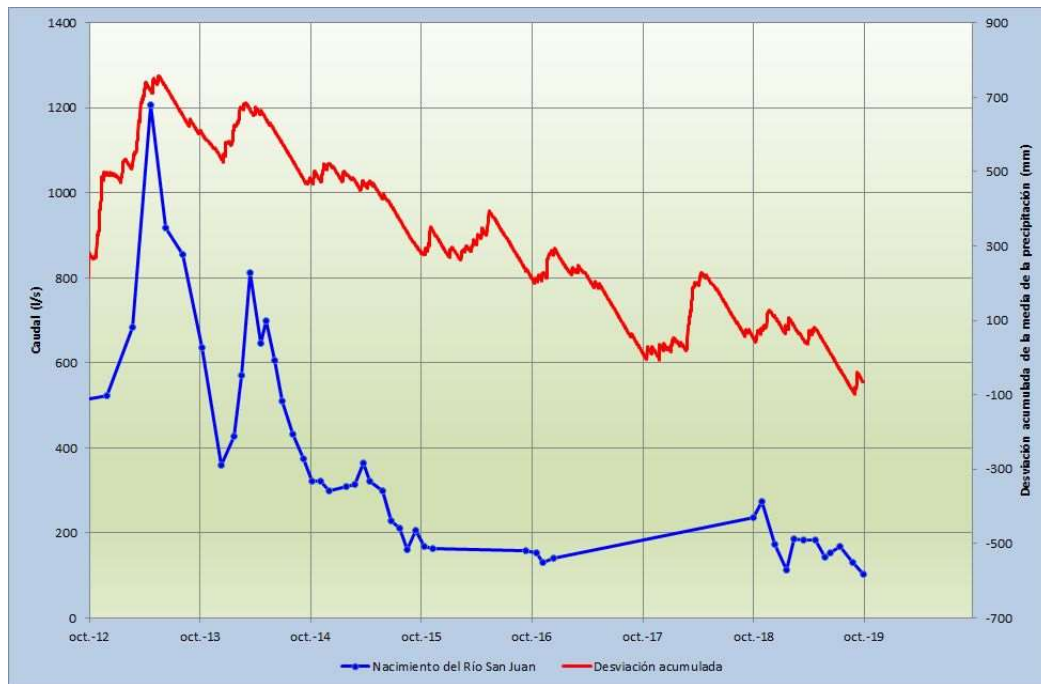
Figura 7: Comparación entre el hidrograma del Nacimiento del Río San Juan y la desviación acumulada de la precipitación respecto de la media.
