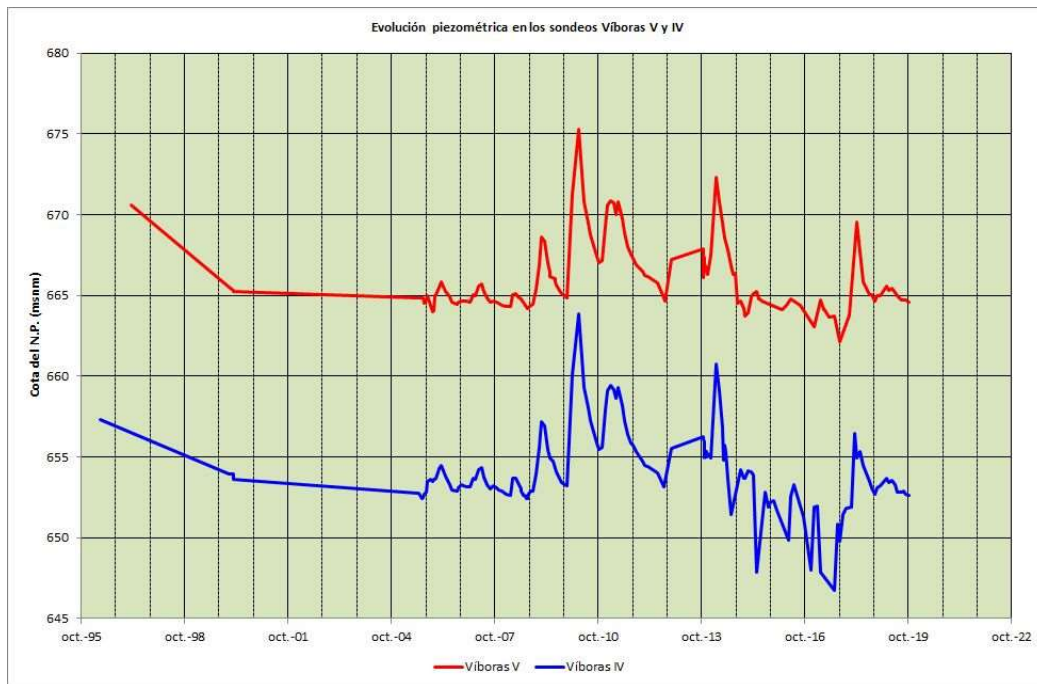
Figura 6: Evolución del nivel piezométrico en los sondeos Víboras V y IV
